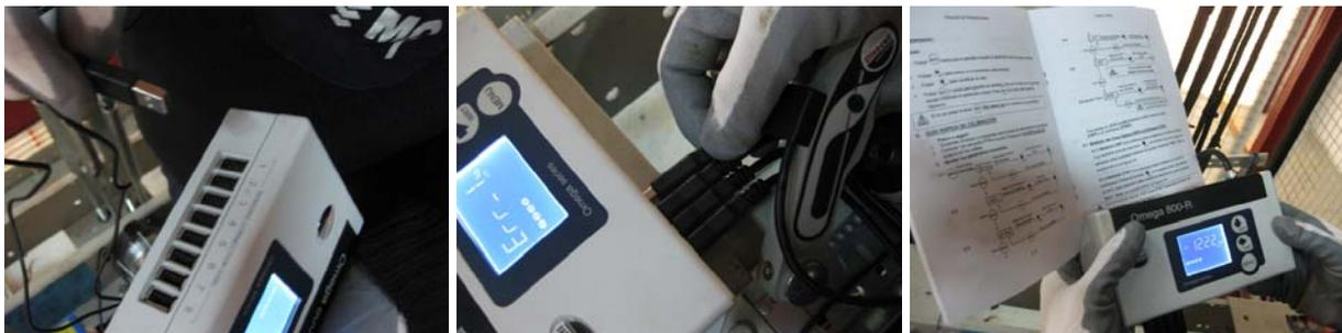
Desarrollo de calibración según instrucciones. Se conectan al equipo de control mediante las conexiones USB.
