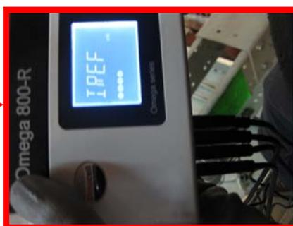
Ver pagina 6 Punto 3.5 A partir de este mensaje **IPEF** en el display se procede a la instalación de los sensores RTM en los cables.
