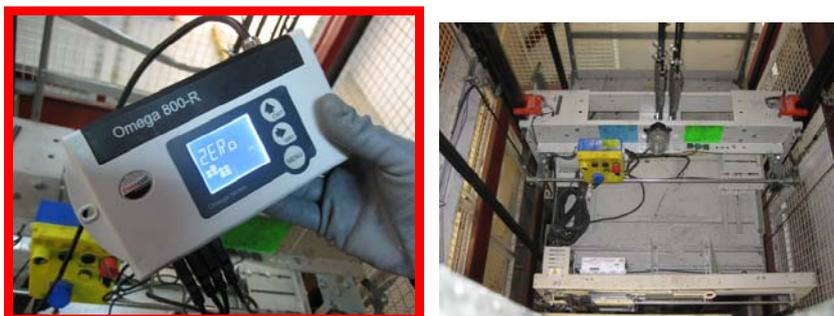
Preparación para la medición: programar el tiempo de salida para permitir abandonar el techo de cabina.
