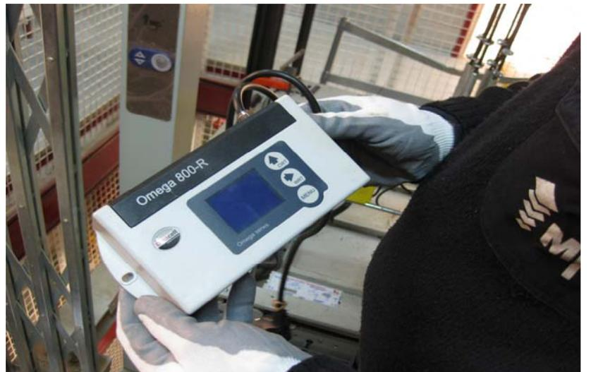
Material a utilizar : Sensores RTM y equipo de control Omega 800-R
